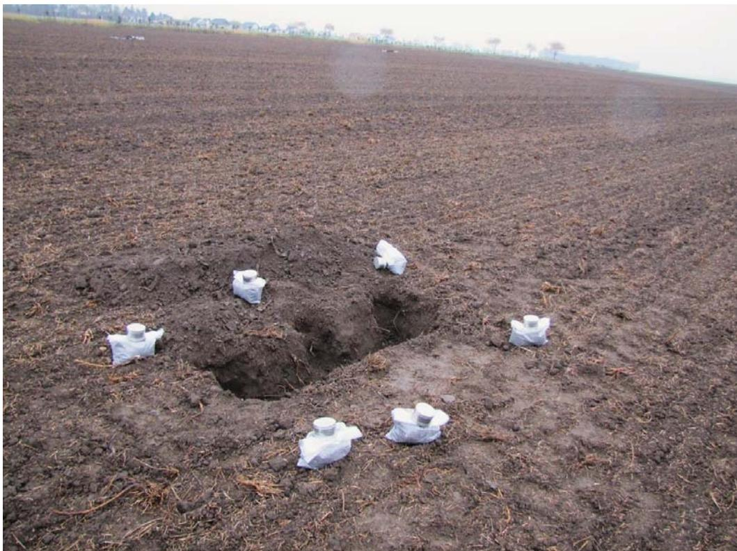
Abbildung 2: Probenahmepunkt mit ungestörten und gestörten Bodenproben
