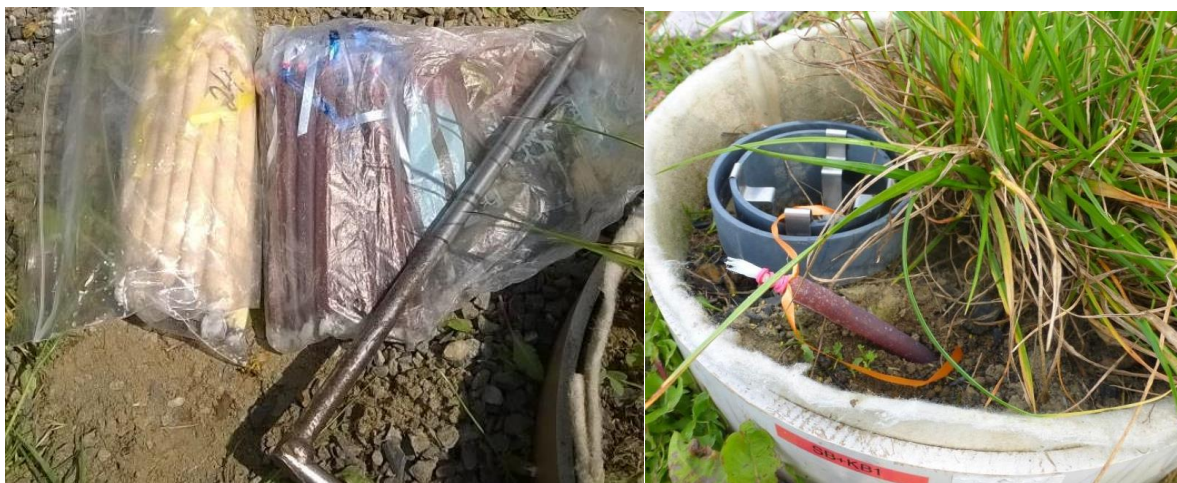
Obrázek 16 Uložení iontoměničových sond v nádobách
