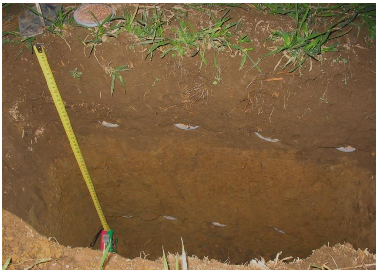
Obrázek 23 Vložení plochých iontoměničových disků do půdního profilu v hloubce 20 a 50 cm.
