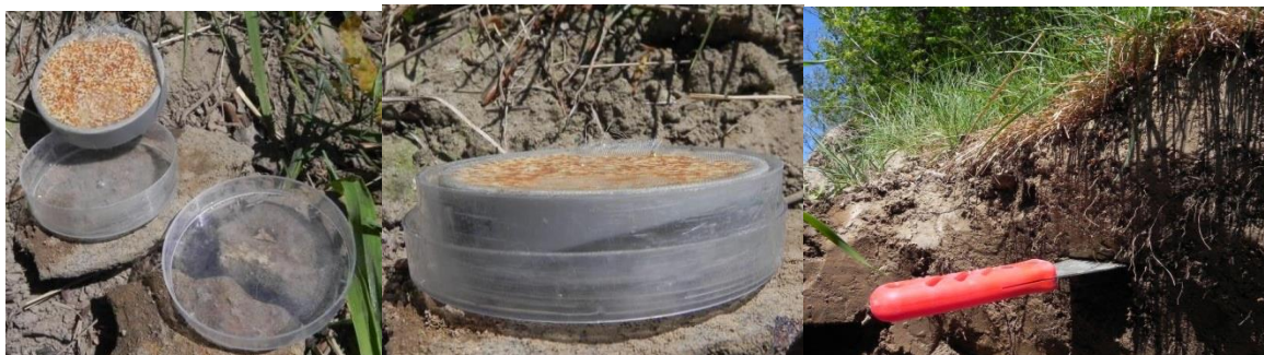
Obrázek 26 Sestavení inovovaných iontoměníčových disků a příprava na jejich zapravení do půdy
