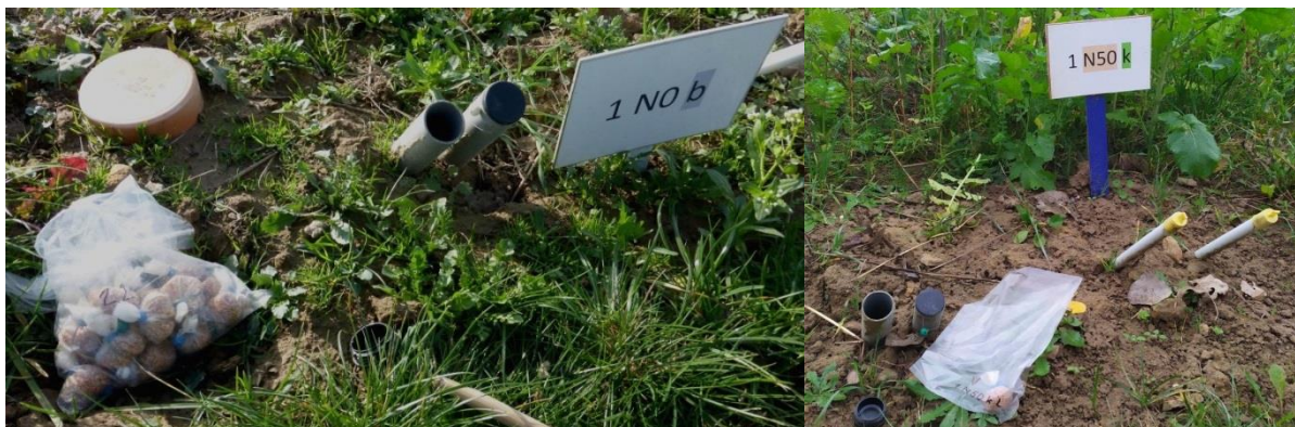
Obrázek 30 Výměna iontoměničových váčků z povrchu půdy
