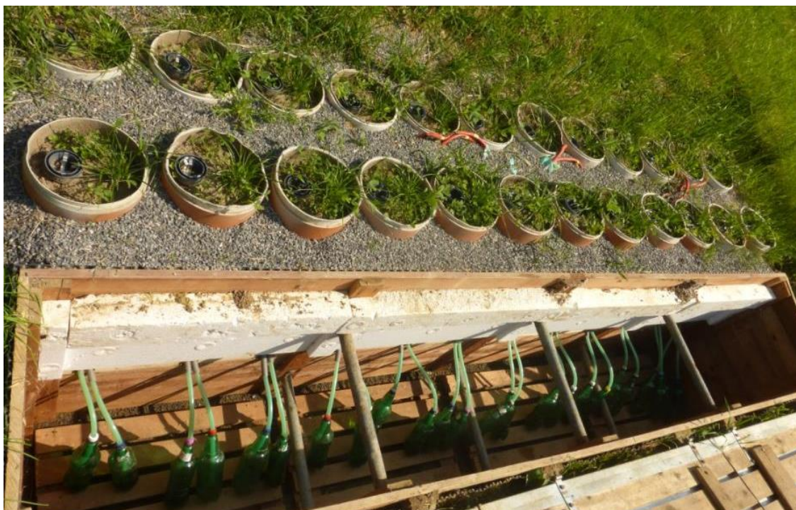
Obrázek 13 Způsob shromažďování protékajících perkolátů
