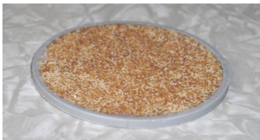
Obrázek 22 Plochý iontoměničový disk připravený k aplikaci do půdy
