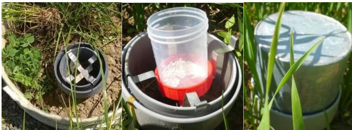
Obrázek 20 Princip měření produkce CO 2
