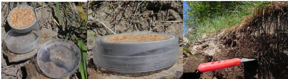
Obrázek 26 Sestavení inovovaných iontoměničových disků a příprava na jejich zapravení do půdy
