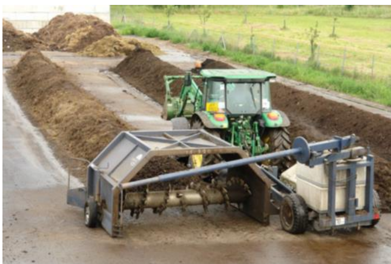
Obrázek 1 Technologie kompostárny na volné ploše s traktorovým překopávačem kompostu
