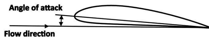
Abb. 2: Die Tragfläche eines Flugzeugs: Wie sieht der Anstellwinkel aus? Die Luftkraft Y wird nach dem folgenden Prinzip erzeugt:
