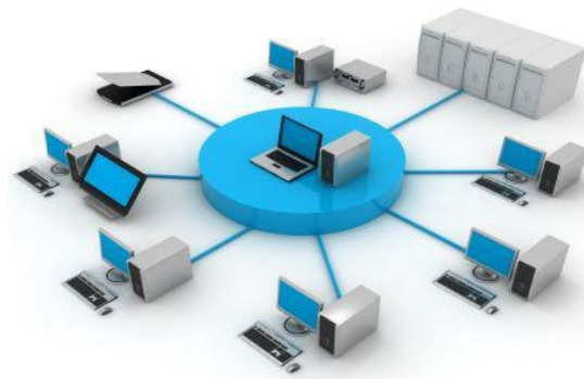
Abb.: Eine sternförmige Netzwerkverbindung
