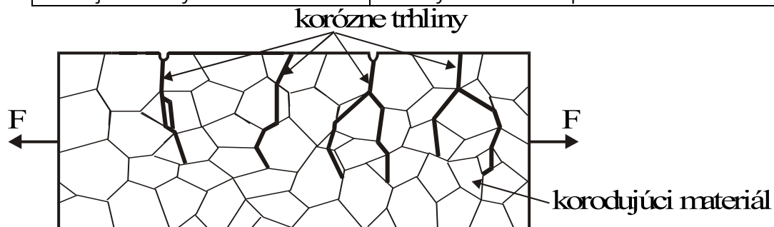
Obr. 7.3 Schéma korozních trhlin
