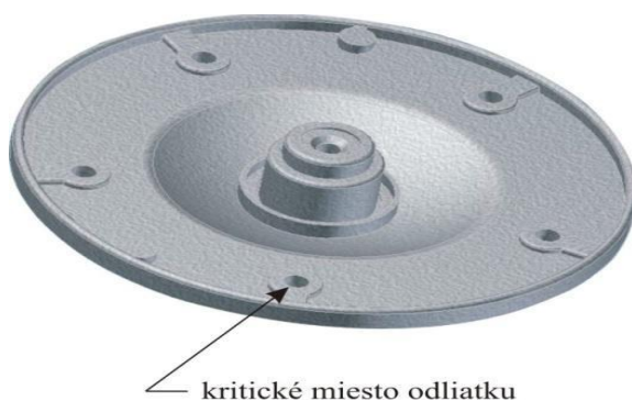
Bild. 1 Elektromotorischer Flansch Text zum Bild: kritischer Punkt im Gussteil
