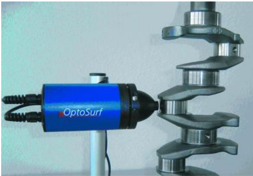
Abbildung 6.18 Messen mit dem Sensor QS 500 [7]
