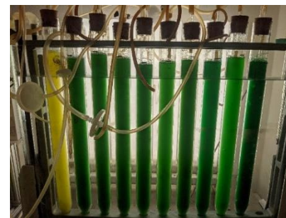
Fig 1 Kultivierung in Glaszylindern für die Analyse verschiedener Abwassertypen.
