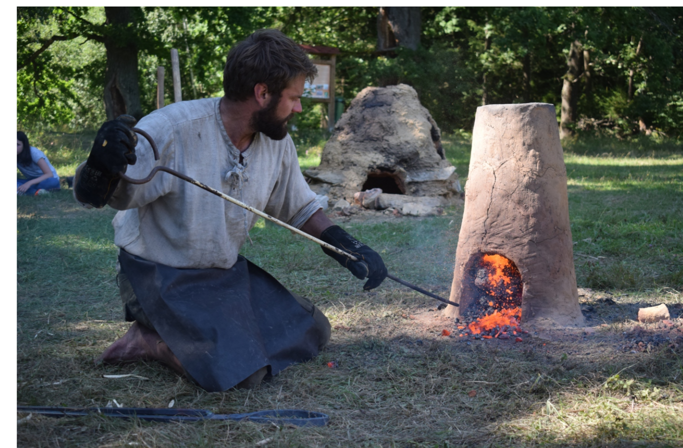
Matěj Kmošek při vytažování tzv. houby po skončení tavby.
