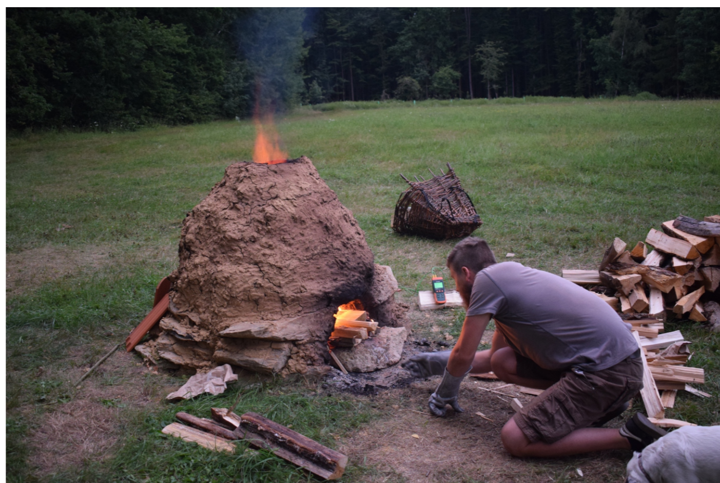
Teplota v peci se musí zvyšovat postupně, jinak by keramika popraskala.
